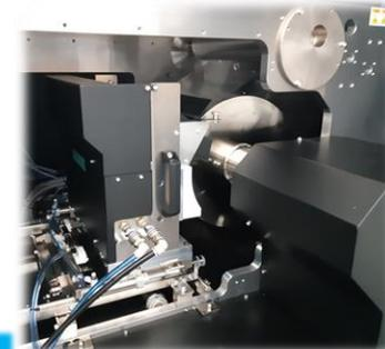
Il sensore rileva la giunta e solleva automaticamente la testa di stampa per prevenire qualsiasi danno.
